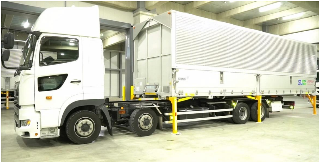
実証実験におけるスワップボディコンテナ交換の様子
